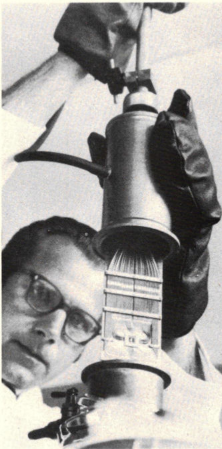
Een natuurkundige van IBM's researchlaboratorium in Zürich laat een experimenteel Josephson-circuit neer in vloeibaar helium. Bij een temperatuur van 4,2 graden boven het absolute nulpunt vertoont het circuit zijn supersnelle schakeleigenschappen.
