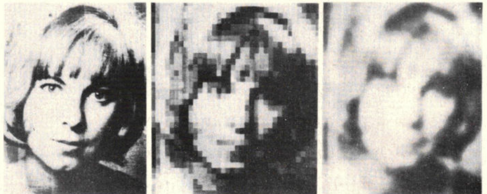
Afb. 5. Datareductie in de praktijk. Het fotografische videobeeld links kan in beeldvlakjes aanzienlijk in verwerkingsgegevens worden teruggebracht, terwijl het beeld zelf voor de mens herkenbaar blijft. De in de tekst beschreven delta- en DPCM-modes leiden tot het gereduceerde beeld rechts, dat eveneens herkenbaar blijft.
