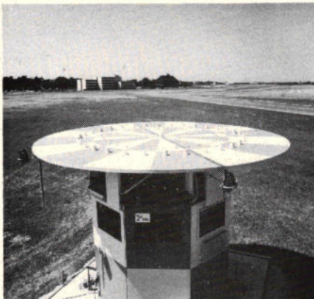
Afb. 2. Proefstation DLS-A. Op het dak een kring van monopool-antennes voor de azimutmeting.
